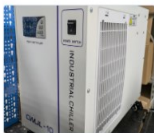
Raffreddamento ad acqua per il laser plastica
